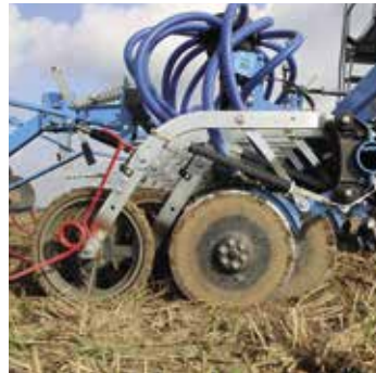
Das OptiDisc Doppelscheibenschar mechanisch bis 45 kg Schardruck
