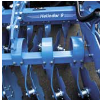
Scheiben im Bereich der Traktorspur separat einstellbar
