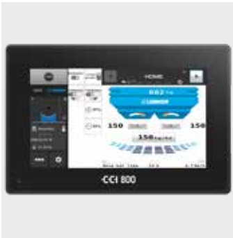
CCI 800 ISOBUS-Terminal für ECONOV Teilbreitensteuerung
