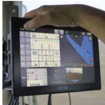
Steuerung mittels CCI 1200 Terminal
