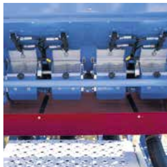
Jeweils zwei Dosierungen für beide Seiten des Behälters
