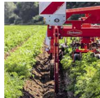
Optionaler Tiefenlockerer zur Lockerung des Bodens zwischen den Dämmen
