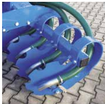
Injektion des Düngers hinter der ersten Scheibenreihe
