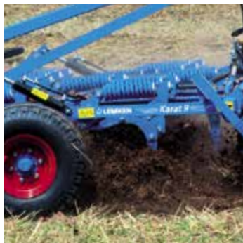
Tiefensteuerung am Grubber
