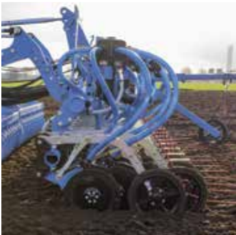
Verteiler über der Säschiene
