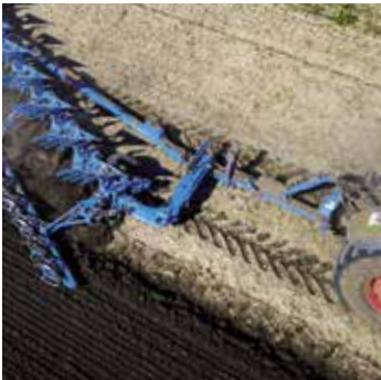
Großer Freiraum zwischen Pflugturm und Drehwerk
