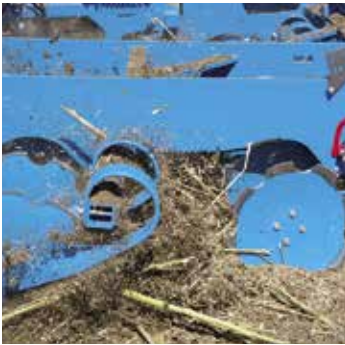
Vertikal arbeitende Scheibenreihen
