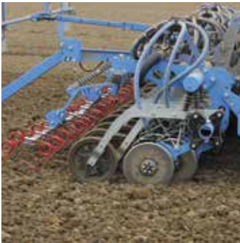
Das OptiDisc Doppelscheibenschar hydraulisch bis 70 kg Schardruck
