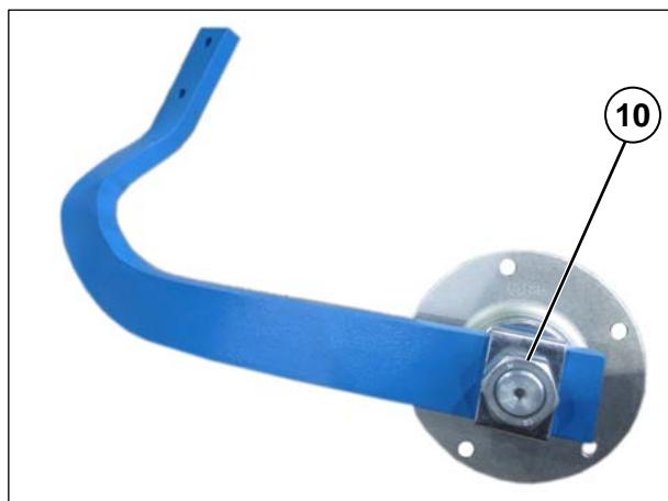
Die Muttern (10) der vorderen und hinteren Hohlscheiben weisen unterschiedliche Gewinde auf.
