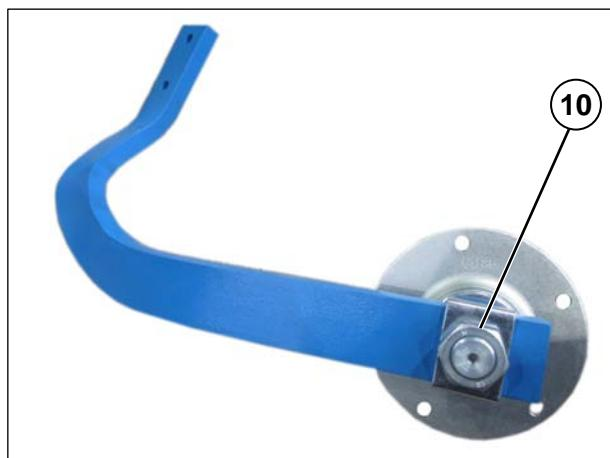
Les écrous (10) des disques concaves avant et arrière ont des filetages différents.
