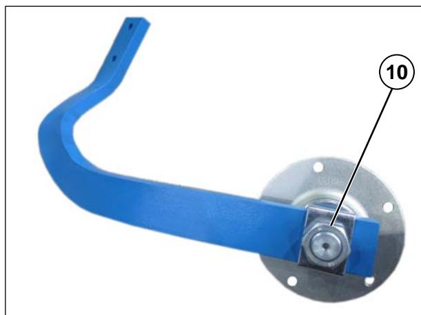
Гайки (10) переднего и заднего сферических дисков имеют разную резьбу.
