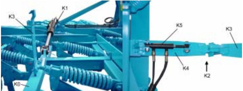
Pour le transport il faut plier les compartiments latéraux (K0) du déchaumeur 'Thorit' 9 KA. Ne plier ou déplier les compartiments latéraux que lors de la machine attelée au tracteur. Les vérins hydrauliques (K1) doivent être branchés sur un distributeur hydraulique à double effet.
