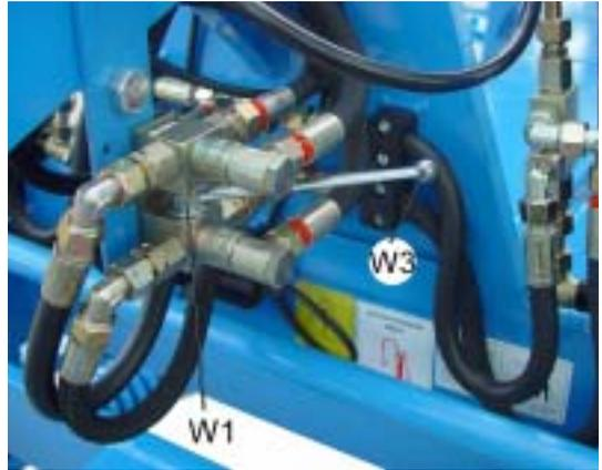
A cause du distributeur 6/2 (W1) le tracteur nécessite un dispositif de commande double effet de moins.
