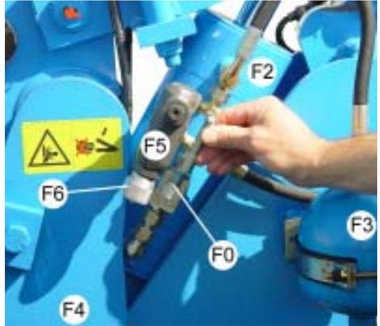
Tourner la roulette (F6) dans le sens des aiguilles d'une montre = pression plus élevée
