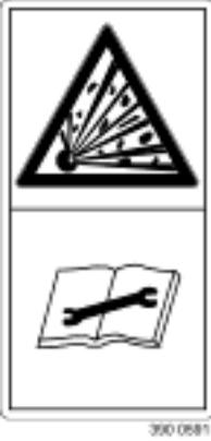
**ATTENTION:** L'accumulateur hydraulique contient du gaz et de l'huile sous pression. Pour la dépose et les opérations de remise en état, se conformer aux instructions du manuel technique.
