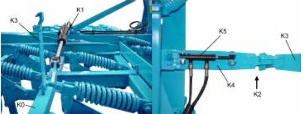
Für den Transport müssen die Seitenteile (K0) des Thorit 9 KA eingeklappt werden. Die Seitenteile dürfen nur mit am Traktor angebautem Gerät ein- und ausgeklappt werden.
