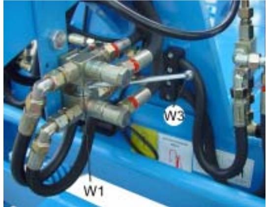
Am Traktor wird durch das 6/2 Wegeventil (W1) ein doppelt wirkendes Steuergerät weniger benötigt.
