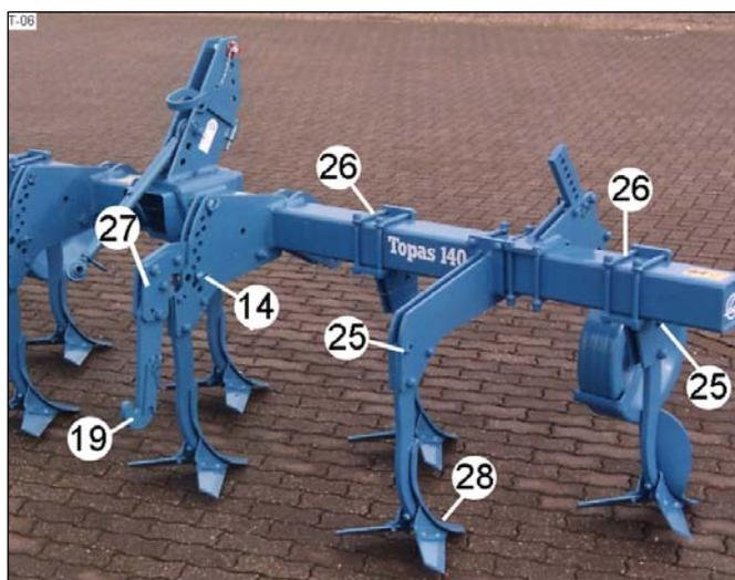
Il est impératif de n'utiliser que des boulons de sécurité M 12x60/8.8, réf. no. 301 3389. Seules ces dimensions et cette qualité empêchent un déclenchement trop précoce, mais protègent efficacement le châssis et les dents.
