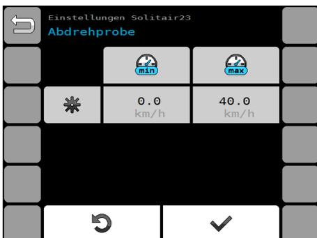
Über den Kalibrierwert [g/Imp] wird die minimale und maximale Arbeitsgeschwindigkeit berechnet.
