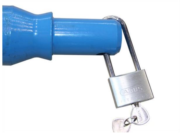
**Schutz gegen unbefugte Benutzung: Zugschiene**
