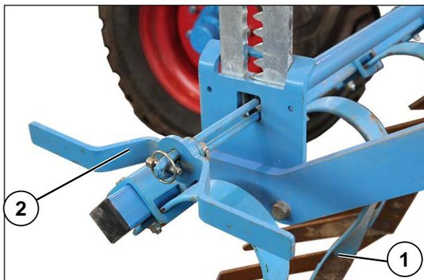
Der Nivellierstriegel (1) füllt die von den hinteren Hohlscheiben hinterlassenen Rillen wieder mit Erdreich auf.
