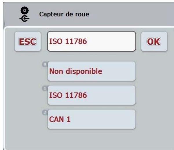
2. sélectionnez la source de signaux désirée depuis la liste de sélection. Pour cela, appuyez sur l'écran tactile sur le bouton avec la source de signaux ou tournez la molette de défilement jusqu'à ce que la source de signaux soit marquée en blanc. Ensuite, la source de signaux apparaît dans la fenêtre de sélection.
