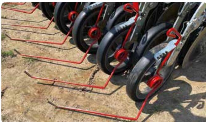
La **herse simple** est montée sur les grains des socs de semence arrière et peut être montée individuellement permettant de régler l'agressivité via une platine perforée. Une seule herse couvre de manière fiable deux rangées de graines.
