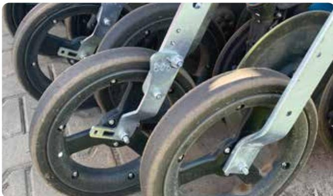
La profondeur de stockage peut être réglée séparément pour chaque deuxième rangée. Ainsi, les **différents composants** (graines, engrais, etc.) peuvent être déposés à différentes profondeurs lors du semis A-B.
