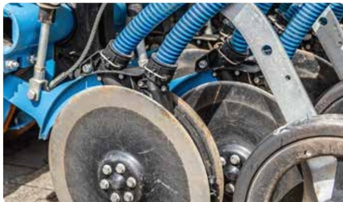
**Dépôt standard, en ligne unique ou double:** avec le OptiDisc 25, tous les processus peuvent être réalisés. Dans la version à semis unique, les deux composants sont mélangés devant la tête de distribution et appliqués ensemble. Dans la variante en rangs séparés, les deux composants sont répartis séparément l'un de l'autre via deux sorties dans le soc à double disque.
