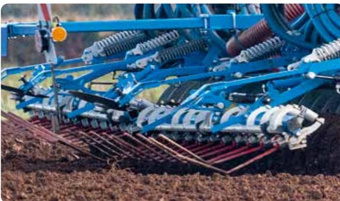
Avec la **herse compacte**, l'angle de travail par rapport au sol est rapidement ajusté à l'aide d'une platine perforée. La pression de la herse se règle mécaniquement ou hydrauliquement.
