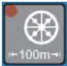
Touche de calibrage pour le calibrage 100 m en cm par impulsion
