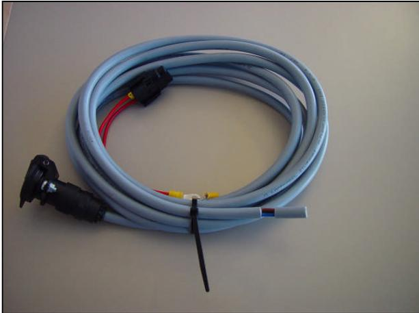
Bei neuen Traktoren, die mit einer Steckdose nach DIN 9680 ausgerüstet sind, kann das Stromversorgungskabel des Beidienterminals oder des Bordcomputers direkt an die DIN-Steckdose angeschlossen werden. Bei älteren Traktoren, die nicht über eine DIN-Steckdose verfügen, ist das mitgelieferte Batterieanschlusskabel erforderlich, das direkt an die Batterie des Traktors angeschlossen werden muss.
