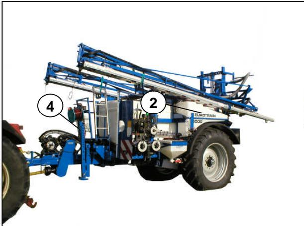
In den Wasserbehältern (2) wird klares Wasser mitgeführt, das bei Bedarf dazu dient, die Restmenge zu verdünnen und die gesamte Feldspritze auf dem Feld zu reinigen. Sowohl die Systemreinigung bei teilbefülltem Hauptbehälter als auch die Systemreinigung bei leerem Hauptbehälter ist möglich.
