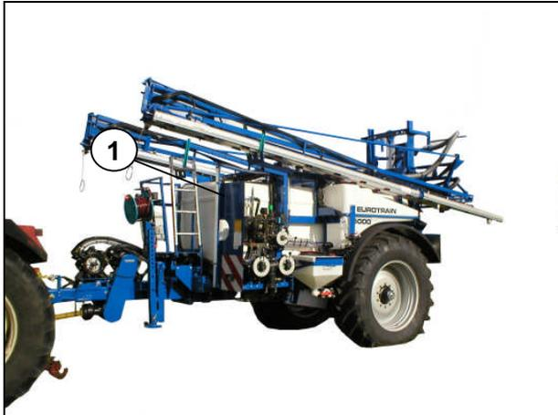
Der Hauptbehälter (1) fasst bei der EuroTrain 5000TC 5.400 l und bei der EuroTrain 6000TC 6.400 l. Die Hauptbehälter dürfen nur mit dem Nennvolumen = 5.000 l bzw. 6.000 l befüllt werden.
