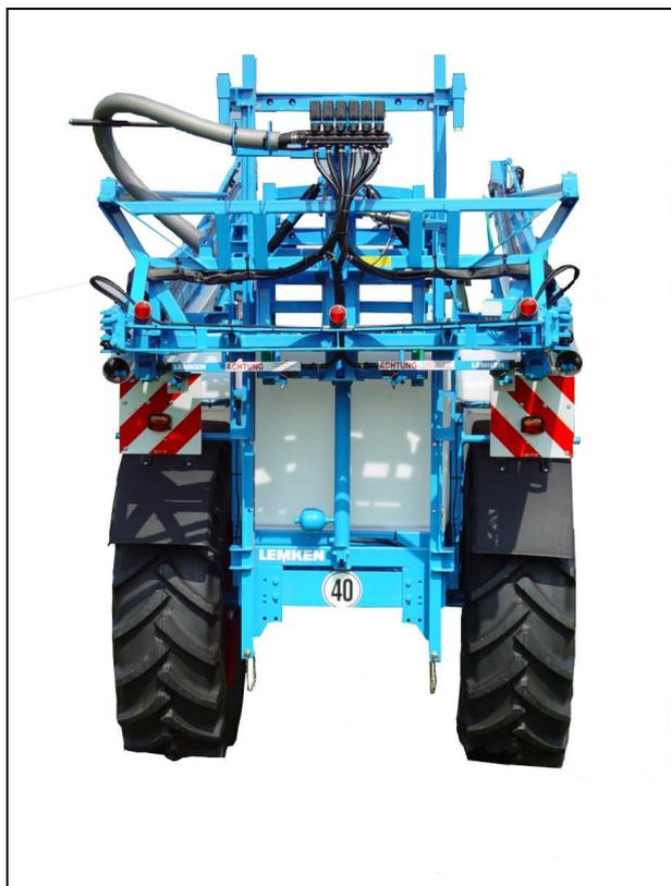
Das HX-Gestänge ist in Arbeitsbreiten von 24m – 28m lieferbar und in Transportstellung ca. 2,5m breit. Serienmäßig wird dieses Gestänge mit der elektrischen Hanganpassung mit Mittenanzeige geliefert.
