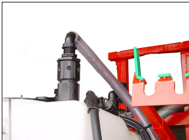
Die Befüllleistung mittels Hydrantanschluss beträgt ca. 700 l/min. Insbesondere im parallelen Einsatz mit dem Einspülsystem müssen im Gegenzug große Mengen Luft aus dem Behälter entweichen. Diese Aufgabe übernehmen zwei separate Belüftungseinrichtungen.
