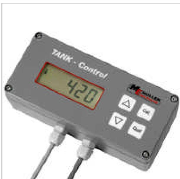
Mit der elektronischen TANK-Messeinrichtung kann der Füllstand sowohl in der Traktorkabine, als auch im Befüllbereich am Gerät abgelesen werden.
