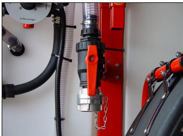
Der Befülldom arbeitet nach dem Injektorprinzip. Die Füllmenge durchläuft die Zwangsbelüftung und gelangt über den Einspülschlauch in den Behälter. Schaltet man das Absperrventil ruckartig auf, kommt es zu einem kurzzeitigen Staudruck, welcher bewirkt, dass Wasser aus den Belüftungsbohrungen austritt. Die Wassersäule kann sich nicht korrekt ausbilden.
