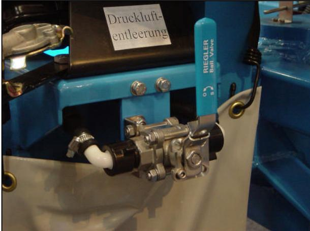
In Verbindung mit der Zirkulationsleitung mit pneumatischer Einzeldüsen-schaltung ist als Zubehör die Düsenentleerung lieferbar. Damit werden die Düsenleitung, die Zuleitung und die Zirkulationsleitung mit Druckluft entleert. Die Entleerung erfolgt in den Hauptbehälter.
