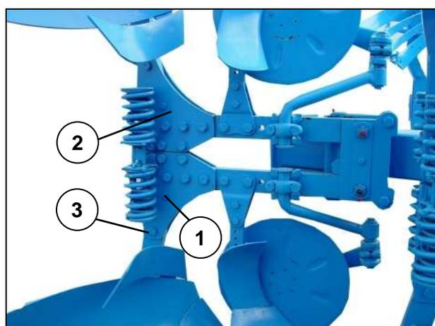
Monter ensuite un nouveau boulon de sécurité et le resserrer, ainsi que le boulon (3).
