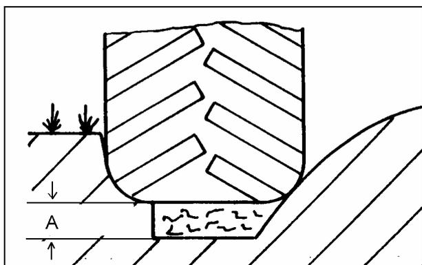
Dans des conditions de sols plus lourds le sol labouré peut montrer des inégalités, causés par le dernier corps travaillant env. 15 cm plus large que les autres corps, une partie du sol sera re-consolidée par les roues du tracteur et par cela la bande de terre suivante sera déposée un peu plus à plat. Mais cela n'a pas d'influence sensible sur les travaux suivants.
