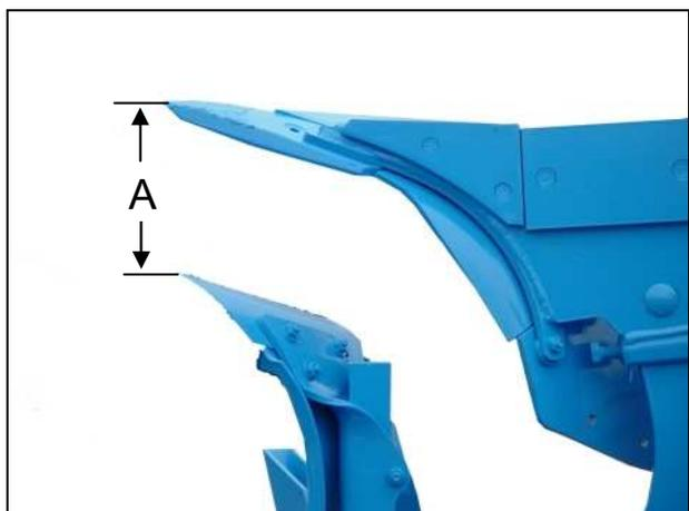
Les rasettes doivent travailler à une profondeur d'environ 5 - 10 cm. Si on laboure p. ex. à une profondeur de 25 cm, les rasettes sont à régler de façon qu'il y ait une distance **A** d'environ 15 - 20 cm entre la pointe du soc de rasette et la pointe du soc de corps de la charrue.
