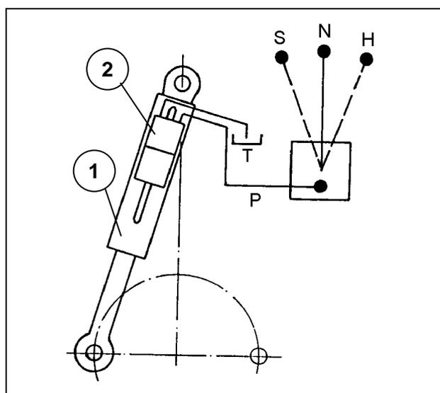
avec bloc de soupape à deux pièces (2) avec couplage de priorité pour des charrues avec alignement hydraulique du châssis ou bien vérin Memory, ou
