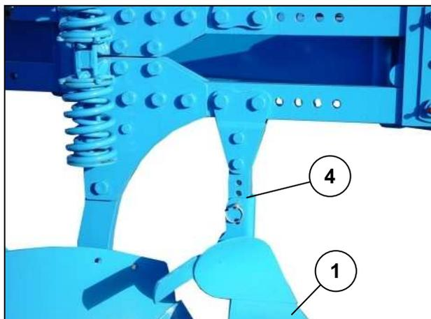
Par déplacement vers l'avant ou vers l'arrière de l'étauçon (4) ou bien de la console du réglage de l'angle de projection la position de la rasette (1) peut être optimisée:
