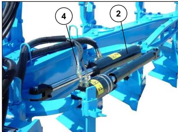
Pour la conversion d'utilisation hors raie = fonction O en travail dans la raie = fonction F, il faut sortir le vérin hydraulique intérieur (2).
