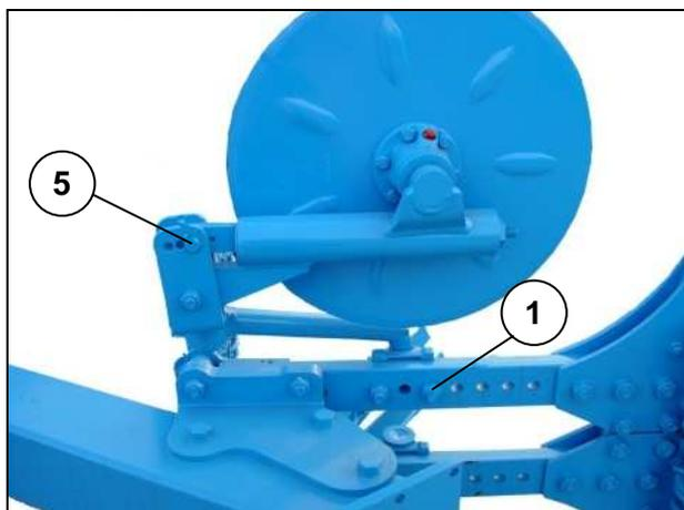
Les coutres circulaires doivent travailler à une profondeur d'environ 7 à 9 cm et à une distance d'environ 2 - 3 cm latéralement par rapport au bord vertical du versoir.
