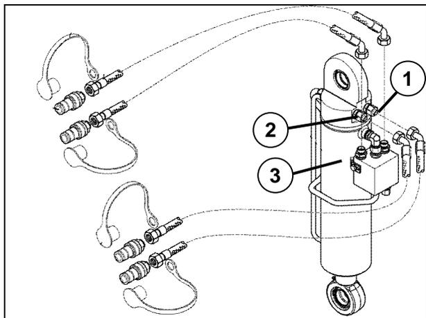
En relation avec un tube distributeur à fonction « memory », l'inclinaison du cadre de la charrue est réglée directement sur le tube distributeur.
