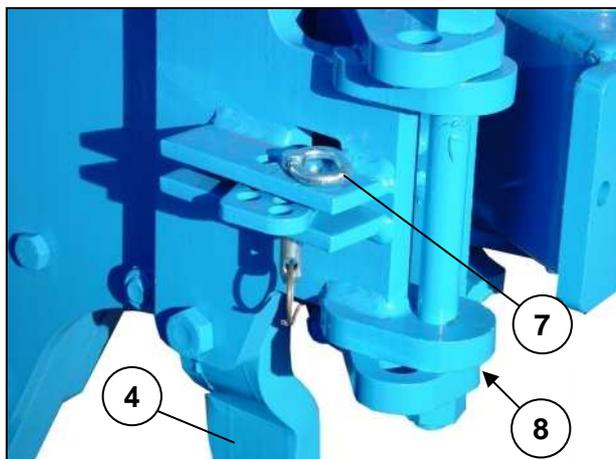
L'angle de projection des rasettes avec étauçons plats (4), qui sont vissées directement sur les consoles d'étauçon (5) ou bien sur les âges des charrues Non-stop, ne peut pas être modifié.
