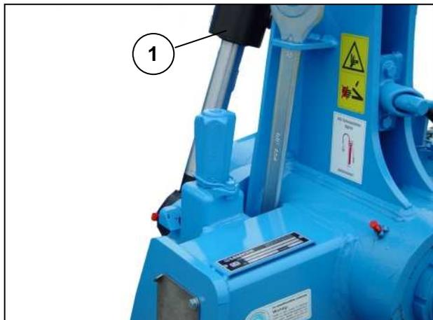
En relation avec un tube distributeur (1) branché à un appareil de commande à effet simple et possédant une conduite de retour vers le réservoir hydraulique du tracteur, l'inclinaison sera réglée comme il est décrit aux points a) – c) du paragraphe précédent.
