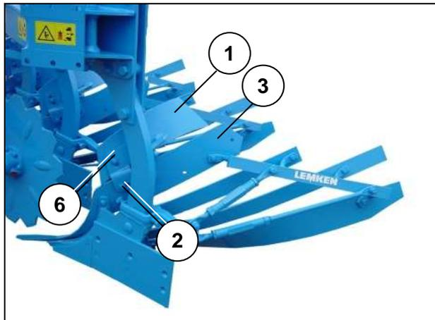
Le déflecteur (1) est boulonné sur le versoir (3) avec son support (2). Le support a des trous oblongs qui permettent un réglage universel.
