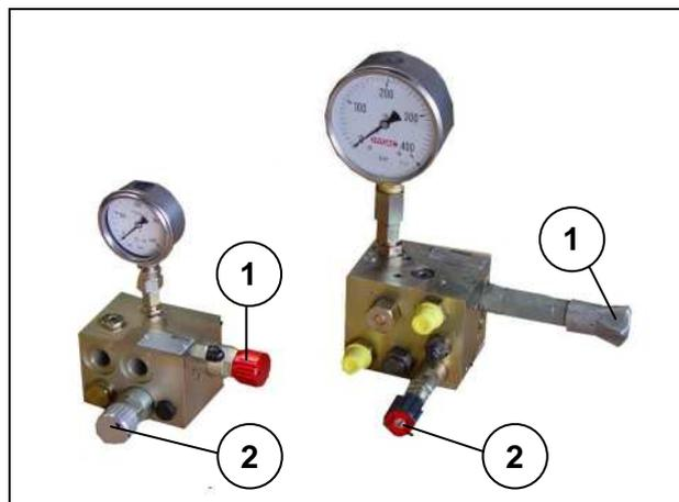
Après avoir branché la vanne de réglage sur le système de commande du tracteur, le système est prêt à fonctionner aux conditions de pression maximum et minimum paramétrées en usine. Si besoin est, il est possible de régler ces pressions pour répondre à des besoins particuliers à l'aide des boutons (1 et 2).
