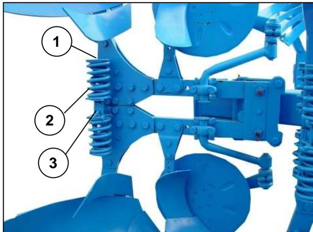
La sécurité Non-stop est réglée de base en usine. Si les corps se déclenchent sans rencontrer d'obstacle il faut augmenter la force de rappel de la sécurité Non-stop. Cela se fait en serrant les vis (1). Veiller à ce que tous les ressorts (2) soient réglés de la même manière, pour assurer un fonctionnement parfait de la sécurité Non-stop Tandem.
