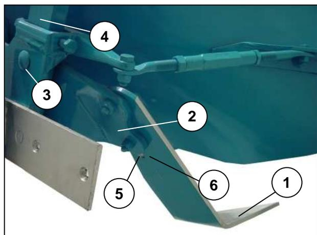
Visser le soc sous soleur (1) avec sa console (2) sur l'étauçon (4) au moyen des vis plus longues (3). Les trous (5) permettent le déplacement de l'étauçon (6) pour l'ajustage d'une profondeur de travail plus plate.
