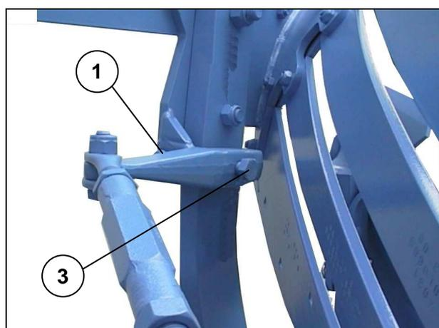
La distance **A** entre les pointes des socs et le bâti de la charrue doit être identique au niveau de tous les corps. La mesure **D** doit s'élever à 1,5 cm. Des réglages nécessaires sont faits au moyen des vis de réglage (1). Pour cela desserrer un peu les vis du corps (2) et les vis de serrage (3).
