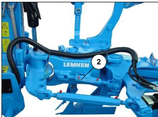
Régler la ligne de traction à l'aide de la vis intérieure (2) de telle sorte qu'il n'y ait plus de force latérale.
