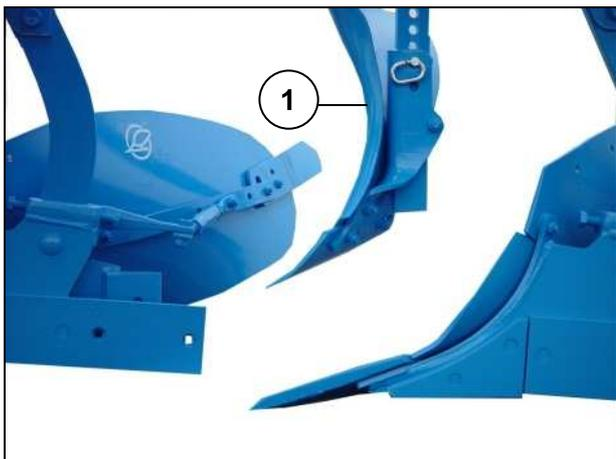
Les rasettes (1) doivent pénétrer à une profondeur comprise entre 5 et 10 cm dans le sol, et vu de dessus, elles doivent se trouver à environ 2 - 3 cm latéralement de la ligne du soc.
