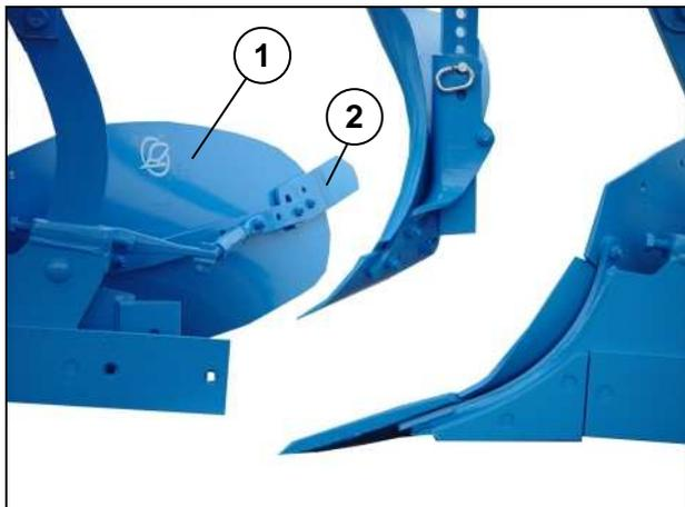
Les prolonges (2) se trouvant aux extrémités des versoirs (1) doivent aider le versoir à retourner la terre, et leur réglage doit être aussi uniforme que possible. En cas de réglage trop profond ils pénètrent dans les mottes de terre déjà retournées, et des morceaux peuvent retomber dans la raie.
