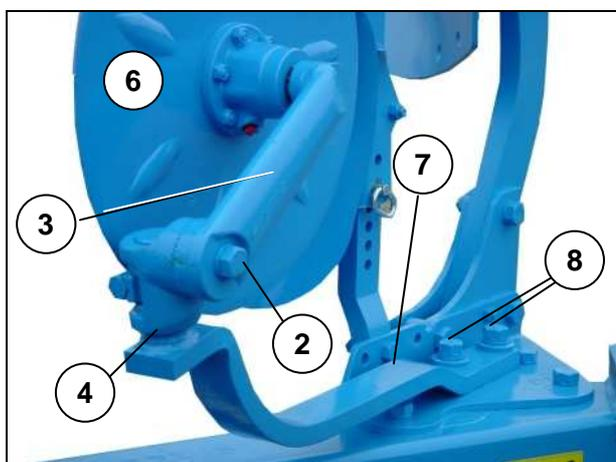
Après avoir desserré le boulon (2), la profondeur peut être réglée, en pivotant le bras (3). Il faut s'assurer que les crans du bras de couteau (3) et ceux du palier (4) s'engrènent correctement les uns dans les autres avant le resserrage du boulon (2).
