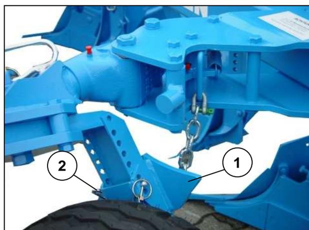
La profondeur est ajustée en déplaçant la butée (1).
