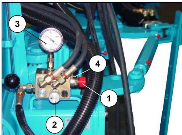
Le système hydraulique doit toujours être mis hors pression pour des travaux de maintenance ou de réparation. Pour cela il faut mettre le dispositif de commande du tracteur sur la position flottante avec la charrue abaissée et ouvrir la vanne de détente (4) qui se trouve derrière un capuchon.
