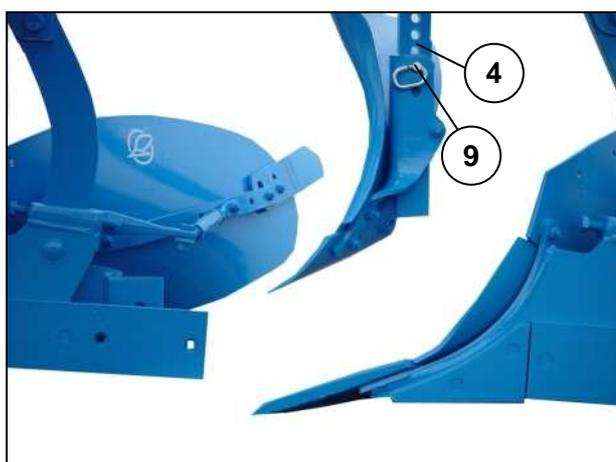
Le réglage de la profondeur de travail des rasettes avec étauçons plats (4) se fait en déplaçant une cheville (9), tandis que le réglage des rasettes avec étauçons ronds se fait à l'aide de vis de serrage. Après resserrer à fond les vis de serrage.
