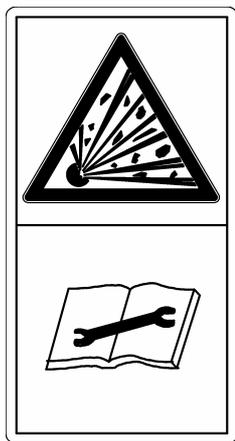
**ATTENTION !** L'accumulateur hydraulique contient du gaz et de l'huile sous pression. Pour la dépose et les opérations de remise en état, se conformer aux instructions du manuel technique.
