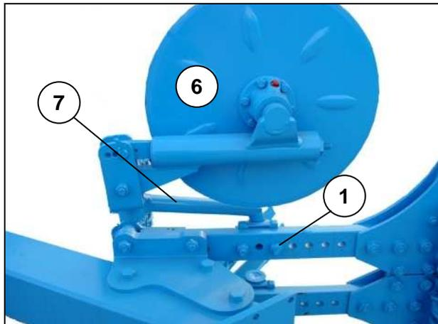
La distance latérale entre le disque (6) du coutre et le bord du versoir est réglé en faisant pivoter l'étançon rond resp. l'étançon plat (7) après avoir desserré le boulon de serrage (1 resp. 8).
