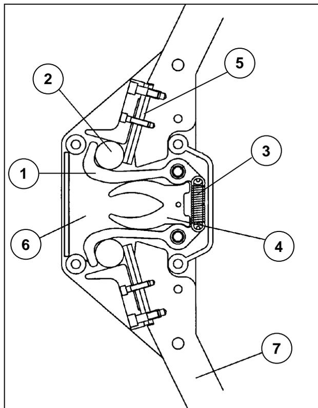
Il s'agit d'un système compact, constitué par des crochets (1), des rouleaux (2), et des ressorts (3,4 et 5). L'ensemble est disposé dans la console d'étauçage (6), et se trouve ainsi protégé.
