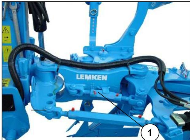
Il faut vérifier qu'il y ait assez d'espace libre entre la charrue/roue et le sol. Si non, raccourcir légèrement la vis intérieure (1), fixer la barre d'attelage plus bas, le troisième point plus haut sur la tête de la charrue, ou bien monter un vérin de réaligement de la poutre.
