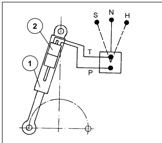
Le dispositif de retournement est équipé d'un vérin hydraulique (1) double effet avec inverseur automatique et blocage automatique d'inclinaison. Ce vérin peut également être commandé par un distributeur simple effet et un retour libre au réservoir d'huile du tracteur.
