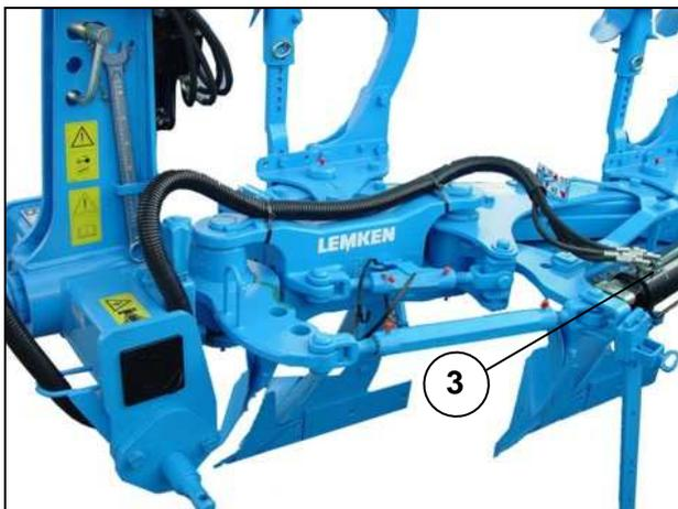
**Attention !** En relation avec un réaligement hydraulique du châssis par vérin Memory (3) le châssis de charrue pivote d'abord vers l'intérieur avant le processus de retournement et se réaligne après !
