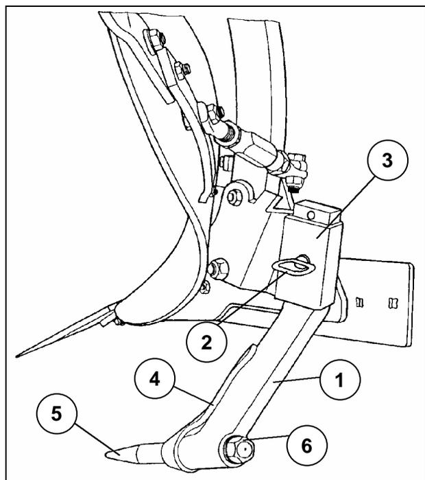
Monter le pic sous-soleur UD6 de façon montrée sur le dessin ci-contre. Par un déplacement de l'étauçon (1) on peut adapter la profondeur de travail du pic sous-soleur.
