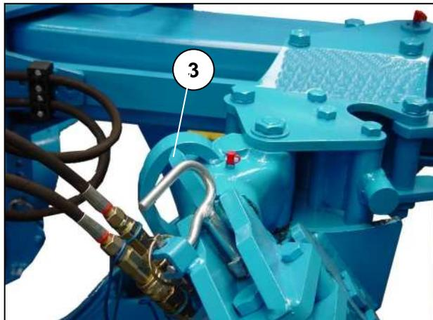
Sur la roue réglable hydrauliquement la profondeur de travail peut être ajustée au moyen d'un dispositif de commande à partir du siège de tracteur. Pour ne pas avoir de patinage ou bien un guidage plus mauvais en profondeur il est recommandé d'adapter à côté de la longueur du bras supérieur et de l'inclinaison aussi le réglage du relevage de tracteur. L'aiguille (3) montre le rayon de profondeur réglé.
