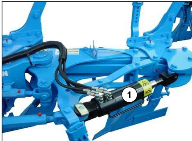
Le vérin Memory est relié au vérin de retournement par deux tuyaux flexibles hydrauliques et à un dispositif de commande double effet du tracteur par deux autres tuyaux hydrauliques.
