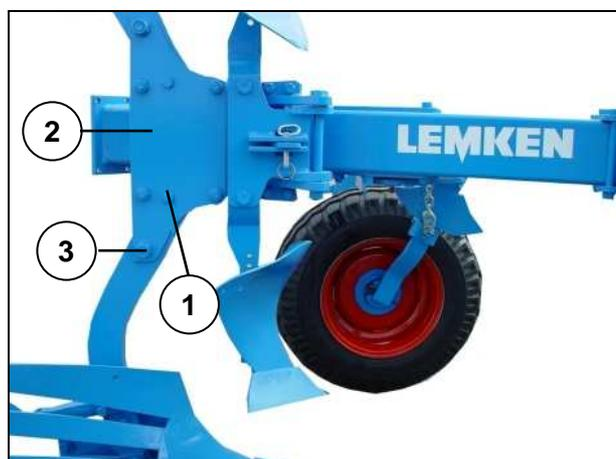
A l'exception de la version HX la charrue est protégée des surcharges par des boulons de sécurité (1) dans les supports d'étauçon (2).
