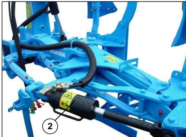
Après avoir régler de base la charrue avec le centre de réglage OPTIQUICK on peut régler la largeur de travail selon le besoin à partir du siège du tracteur au moyen d'un vérin de réglage de la largeur de travail (2) ou bien le vérin Memory (1).
