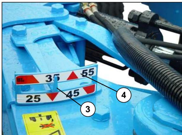
La largeur ajustée est indiquée sur l'échelle (4) au moyen de l'aiguille (3).
