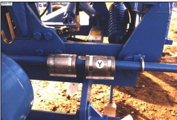
Arbeitsstellung, Klemmanschläge (Y) auf den vorderen Träger der Beleuchtungsanlage aufgeschoben.
