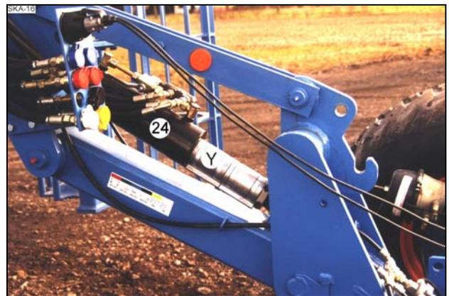
Transportstellung, Klemmanschläge (Y) auf der Kolbenstange aufgeschoben.
