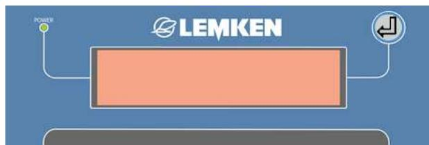
Alternativ kann der Kugelhahn auch über den Taster der elektronischen Füllstandsanzeige TankPilot betätigt werden.
